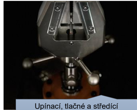
Upínací, tlačné a středící přípravky. Výběr podle jmenovité síly, povrchu, četnosti zkoušení, normy atd.
