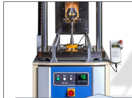
Teplotní komory s rozsahem od -196°C do +350°C integrované ve stroji EP série 1
