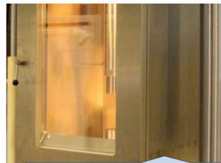
Teplotní komory s rozsahem od – 196°C do + 450°C.
