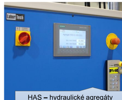
HAS – hydraulické agregáty určené pro statické zkoušky s integrovanou diagnostikou HALT 18 – Simatic.
