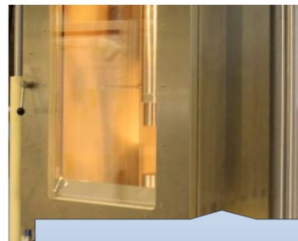
Teplotní komory s rozsahem od – 196°C do + 450°C.
