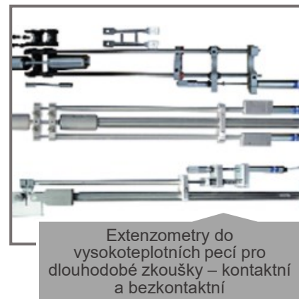
Upínací a středící přípravky určené pro dlouhodobé zkoušky s přípravky do vysokoteplotních pecí.
