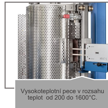
Extenzometry do vysokoteplotních pecí pro dlouhodobé zkoušky – kontaktní a bezkontaktní
