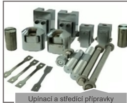
Upínací a středící přípravky určené pro dlouhodobé zkoušky s přípravky do vysokoteplotních pecí.
