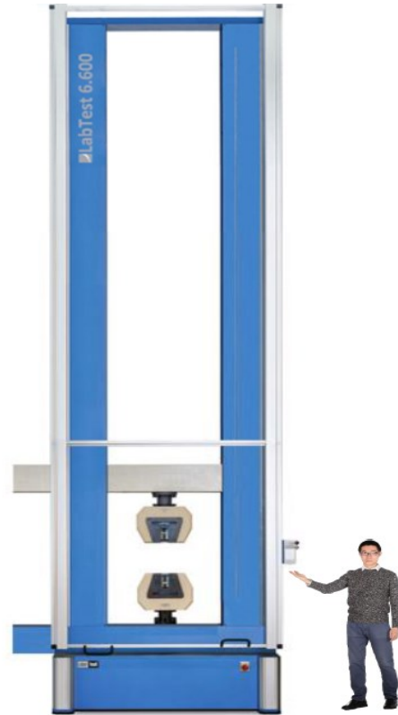
Zkušební stroje řady E.3 s výškou zkušebního prostoru až 6000 mm nacházení využití například ve STAVEBNICTVÍ
