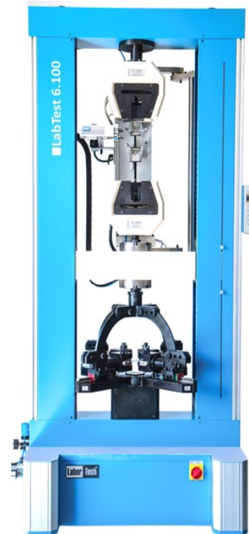
Zkušební stroje řady E.3 s dvěma pracovními prostory pro tahovou zkoušku, biaxiální zkoušku a zkoušku ERICHSENEM - KOVY
