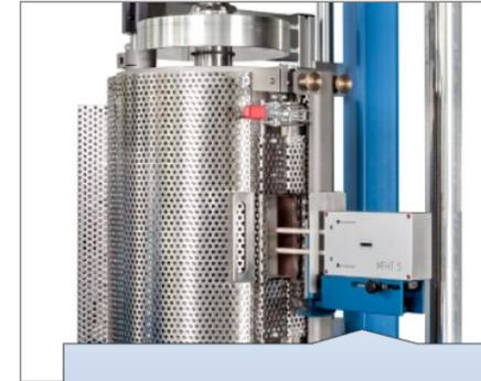
Vysokoteplotní pece do teplot 1600°C.
